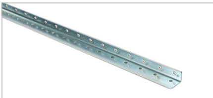
Winkelschiene 4 mm, 120, 150, 180 und 240 cm oder nach Wunsch, mit 9 mm Löchern im Abstand von 5 cm
